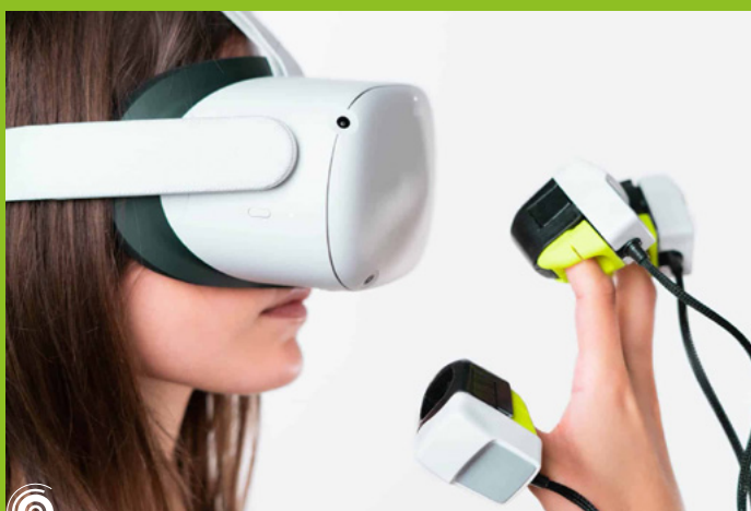
Le gant tactile sensible à la chaleur, conçu avec SolidWorks par Weart, dédié aux applications de Réalité Virtuelle. Doc. e-Novia
